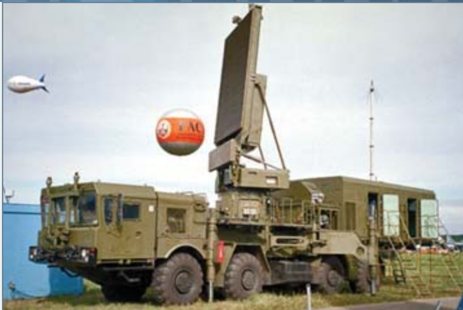
Радар за осматрање 96Л6Е расклопљен на возилу
